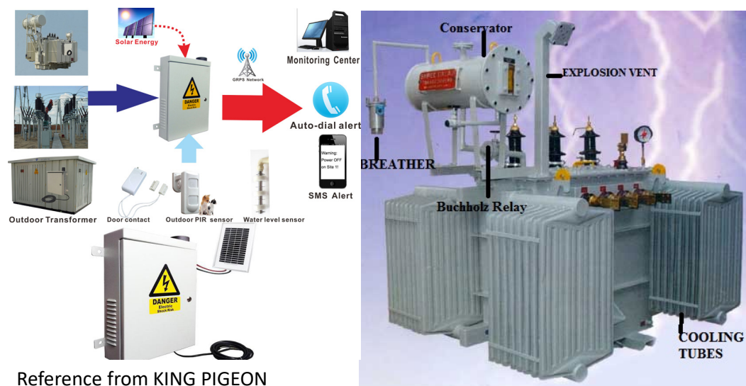
圖2. 狀態監測系統內部結構。
